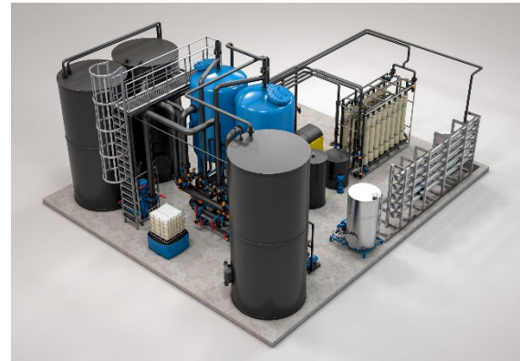
Bild: Mit einer Anlage zum Recycling von Brüdenkondensat kann wertvolles Frischwasser gespart werden (Modell)
