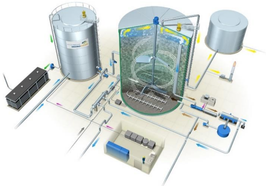
Schematische Darstellung des Biomar AWR-Verfahrens zur Energiegewinnung aus Molkereiabwasser von EnviroChemie
